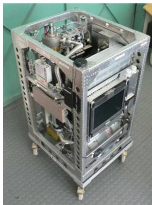
**3 voies de mesure chq 1,5 s → Profils horizontaux 100-200m & Profils verticaux 2-5m résolution**
