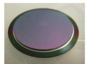
Diode PIPS+ électrode BDD
