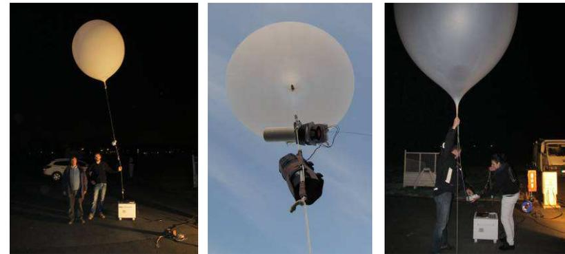
**Instrument** : Radiomètre bande large K&Z (LMD)
