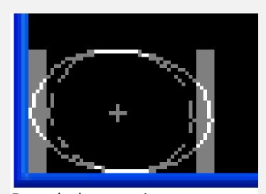
Exemple de correction: goutte échantillonnée pour 170 m/s alors que la vitesse réelle de l'avion est de 130 m/s
