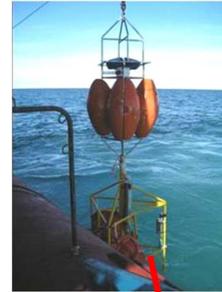
Procédure d'alignement de la cage ADCP sur la ligne de foi du navire
